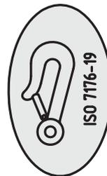
3. Die Sicherungspunkte am Rollstuhl, an denen die Gurte des Rückhaltesystems angebracht werden, sind mit diesem Symbol gekennzeichnet.
