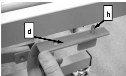
☞ Heben Sie den Liegeflächenrahmen leicht an und schwenken die Halteböcke [d] nach oben, so dass die Zapfen [h] in den Liegeflächenrahmen einrasten
