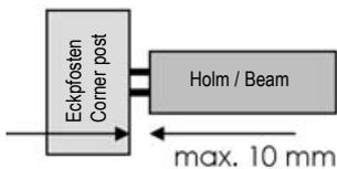
Zwischen dem Liegeflächenrahmen und den Eckpfosten des Betthaupt darf maximal 10 mm Abstand bestehen.
