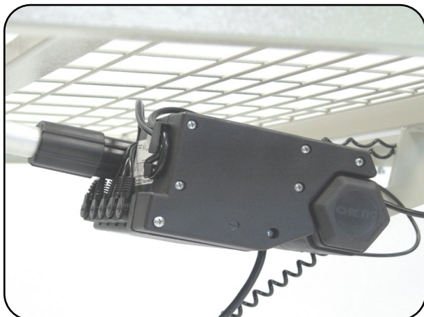
Abb. 6.2.01 - Steuerung an Rückenteilantrieb
