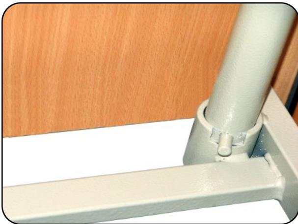
**Abb. 6.3.01 - Aufrichteraufnahmen für Aufrichter (hier: Rundrohr) und Transportsicherung**
