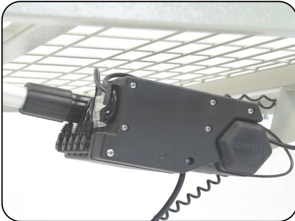
Abb. 6.2.01 - Steuerung an Rückenteilantrieb
